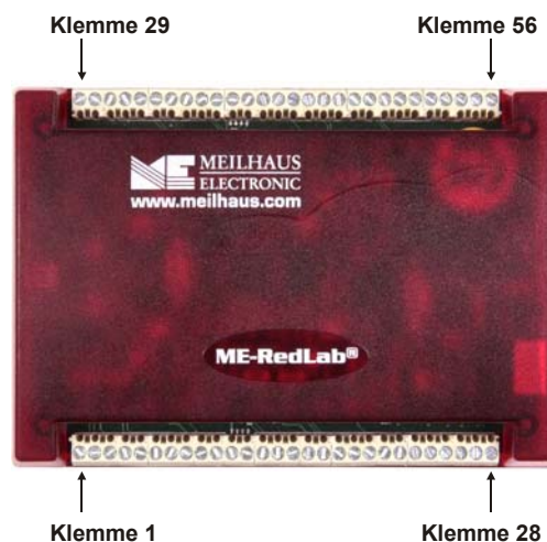
Abb. 3-2. Anschlussbelegung des RedLab 3110
