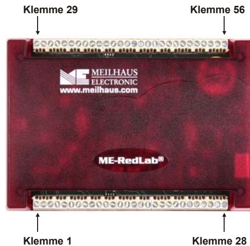
Abb. 3-2. Anschlussbelegung des RedLab 3103
