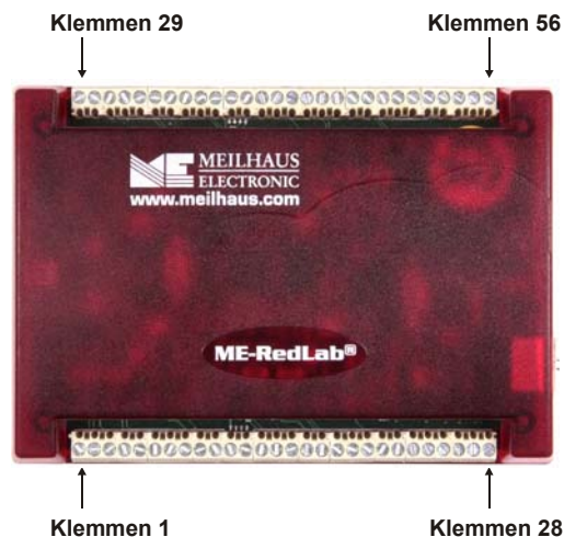
Abb. 3-2. Anschlussbelegung des RedLab 3114
