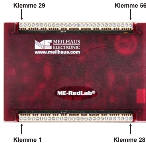
Abb. 3-2. Anschlussbelegung des RedLab 3106
