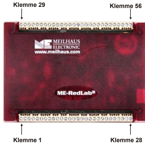
Abb. 3-2. Anschlussbelegung des RedLab 3101
